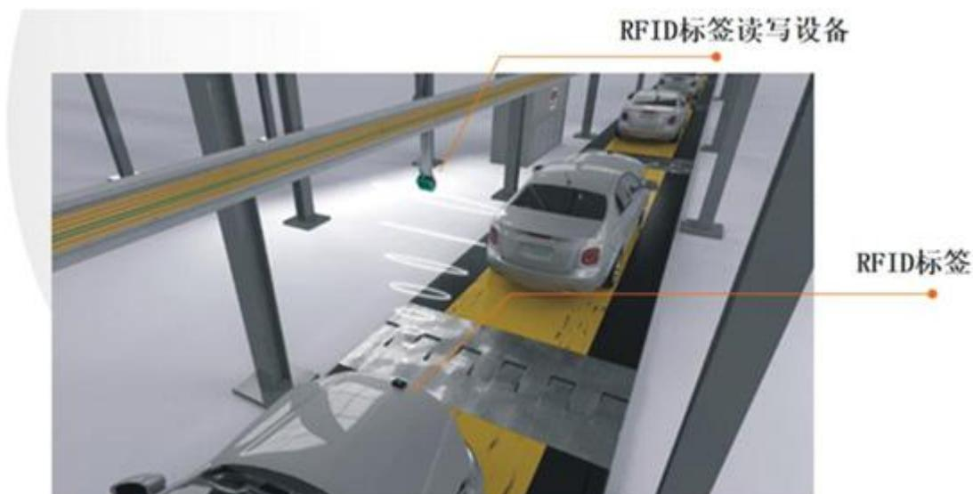
在总装车间，一个焊接喷绘好后的车体，要进行诸多工序，包括车架组装、底盘悬挂，动力合成等等，因此，通过将一个电子标签安装在车体某一个固定的位置，类似于车头，这个标签会跟随整个车体的总装全流程，并在不同的节点安装 RFID 读取设备，来指导工艺的进行。
