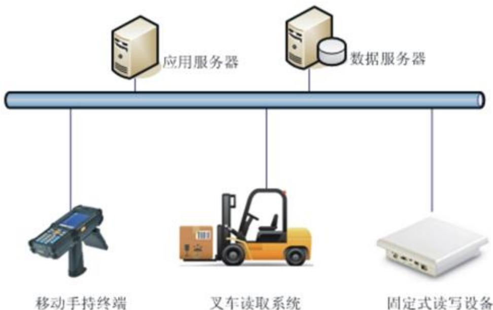
通过对到货的件烟，逐件扫描一号工程件烟条码，再通过 UHF 超高频 RFID 固定式读写设备将条码数据写入相应托盘的电子标签中；对于整托盘到货的件烟，通过 RFID 设备扫描电子标签实现整托盘扫码入库。在仓储环节，使用 RFID 移动设备进行垛信息调整。在分拣领用出
